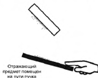
Рисунок В.4d — Отражающий предмет пересекает пучок лазера
