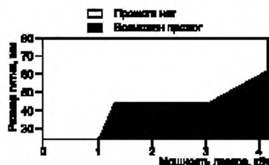
Рисунок F.20 — Стойкость к разрушению листа алюминия толщиной 2 мм от 100 с экспозиции расфокусированного пучка во время экспериментов с использованием непрерывного лазера на иттрий-алюминиевом гранате с неодимом
