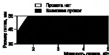
Рисунок F.8 — Стойкость к разрушению листа алюминия толщиной 2 мм от 100 с экспозиции расфокусированного пучка во время экспериментов с использованием непрерывного лазера на углекислом газе
