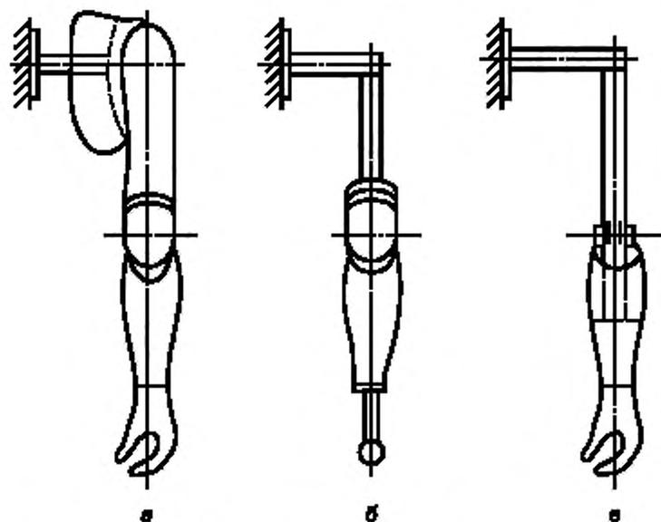
а — модель протеза в сборе; б — узел предплечья, локтевой узел и испытательная оснастка;
