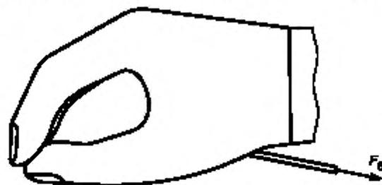
Рисунок 10 — Схема испытания механизма раскрытия пальцев кисти
