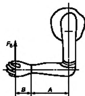
Рисунок 9 — Схема испытания на изгиб вверх
