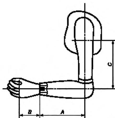
Рисунок 4 — Обозначения длины сегментов образца для испытаний
