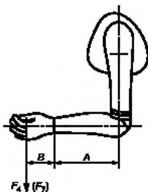
Рисунок 8 — Схема испытания на изгиб вниз
