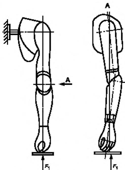
Рисунок 5 — Схема испытания на осевое нагружение
