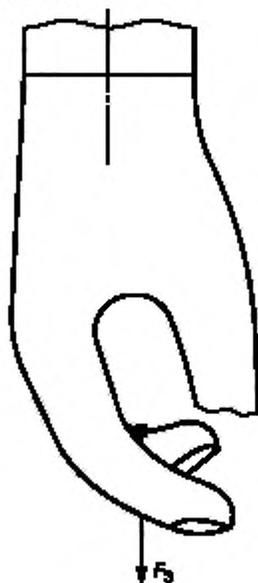
Рисунок 7 — Схема испытания фиксатора пальцев
