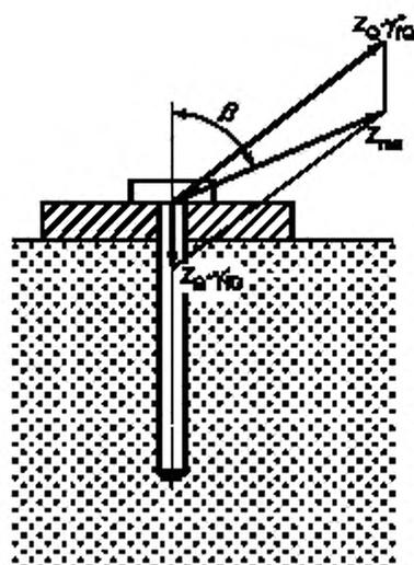
$Z_0$  — благоприятно действующая постоянная нагрузка;  $Z_0$  — неблагоприятно действующая временная нагрузка,  $Z_{res}$  — результирующая нагрузка, действующая на анкер;
