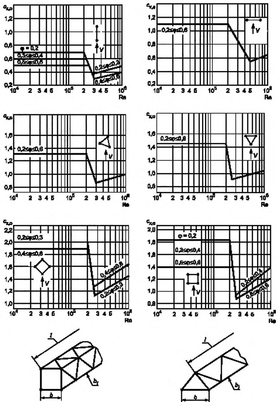
Обозначения  $\varphi$ ,  $l$ ,  $b$ ,  $b_1$  — см. Б.1.6
