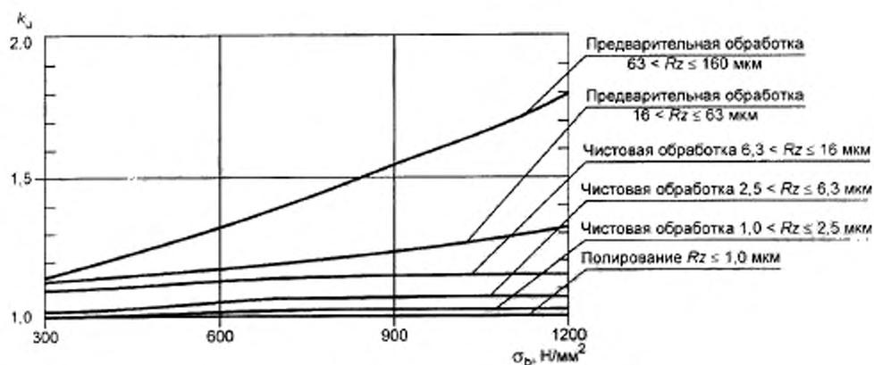
Обозначение:  $Rz$  — параметр шероховатости поверхности
