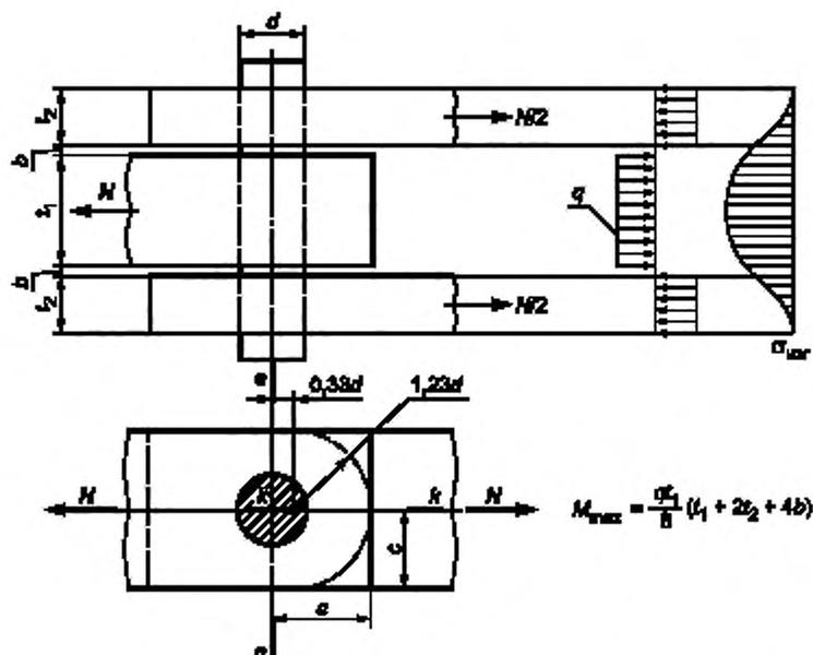
Обозначения.  $M_{\max}$  — изгибающий момент;  $q$  — распределенная нагрузка;  $\sigma_{\text{изг}}$  — напряжения изгиба; остальные обозначения — см. формулы (Н.4), (Н.6) и (Н.7)
