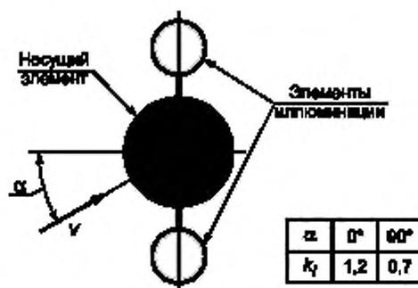
$V$  — направление ветра,  $k_f$  — коэффициент, учитывающий расположение иллюминации относительно направления ветра
