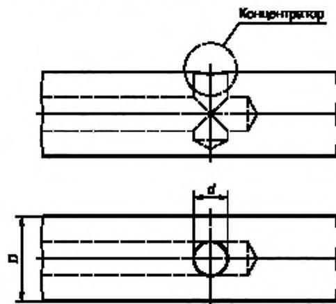
Обозначения:  $D$  — диаметр вала,  $d$  — диаметр отверстия
