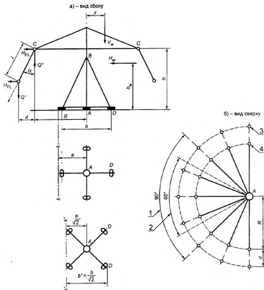
1 — односторонняя нагрузка на 1/4 периметра в соответствии с 7.5; 2 — односторонняя нагрузка на 1/6 периметра в соответствии с 7.6; 3 — вылет гондолы при максимальном угле отклонения подвески; 4 — точка подвески гондолы
