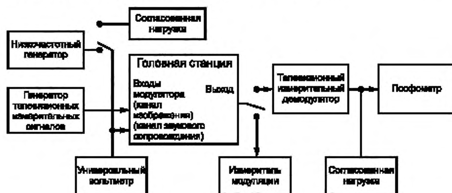
Рисунок 7.28 — Структурная схема для определения отношения сигнала звукового сопровождения к шуму
