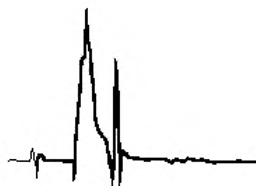
Рисунок В.1 — Хроматограмма томатного кетчупа, не содержащего сорбиновой и бензойной кислот
