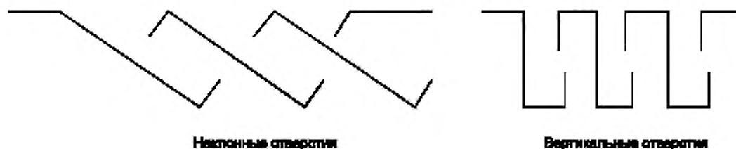
Рисунок 4B — Примеры поперечного сечения конструкции отверстий
