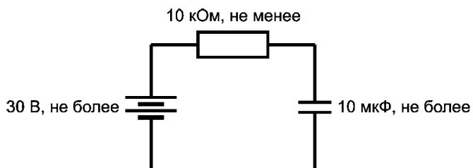
Рисунок А.8 — Простая емкостная цепь
