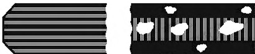
Рисунок А.2 — Грубошлифованная кромка
