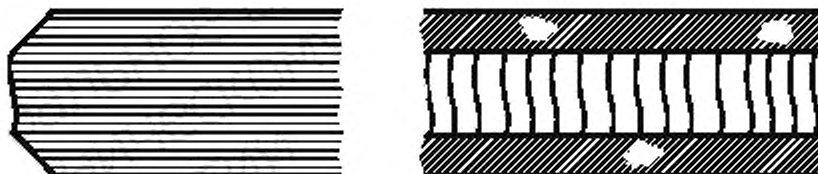
Рисунок А.1 — Притупленная кромка
