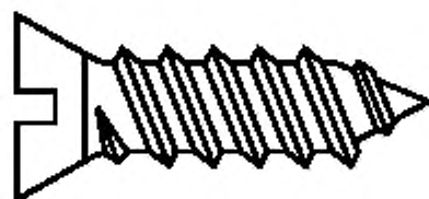
Рисунок А.6 — Самонарезающий формирующий винт
