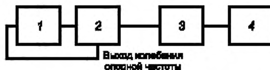
1 — согласующее устройство (эквивалент антенны); 2 — приемник; 3 — измеритель ПОЧ; 4 — универсальный осциллограф
