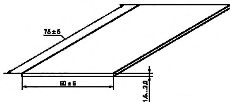
Рисунок А.6 — Заливающая полированная пластинка
