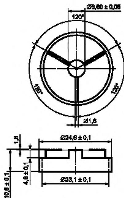
Рисунок А.5 — Накладка для концентрического размещения шарика
