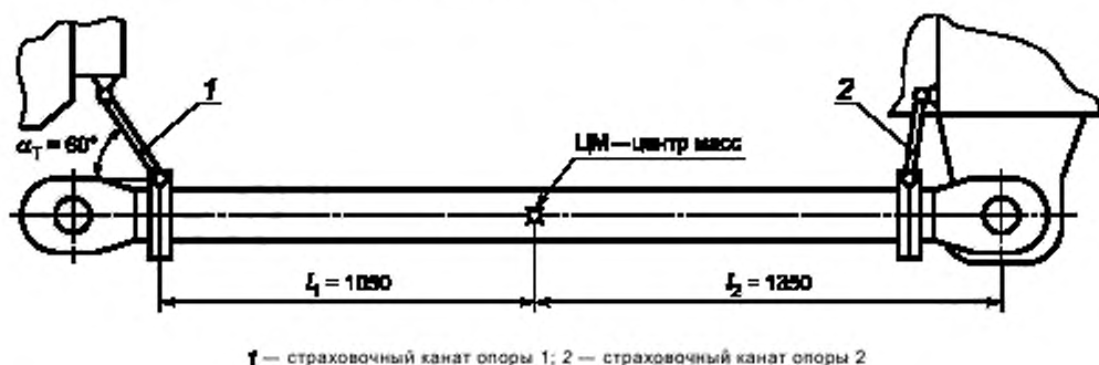
Рисунок А.1 — Конструктивная схема установки страховочных стальных канатов на наклонной тяге
