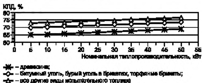
Рисунок 1 — КПД при номинальной теплопроизводительности
