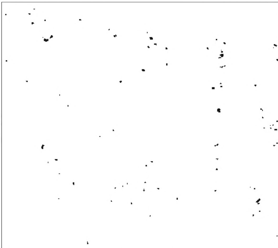
Рисунок Ж.2 — Коррозия металла балл К2 (или Rі 2)
