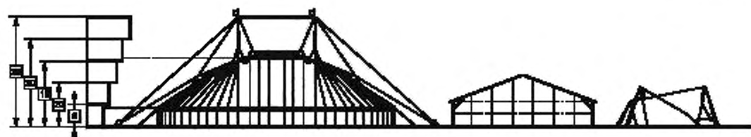
Рисунок 1 — Распределение ветровых нагрузок
