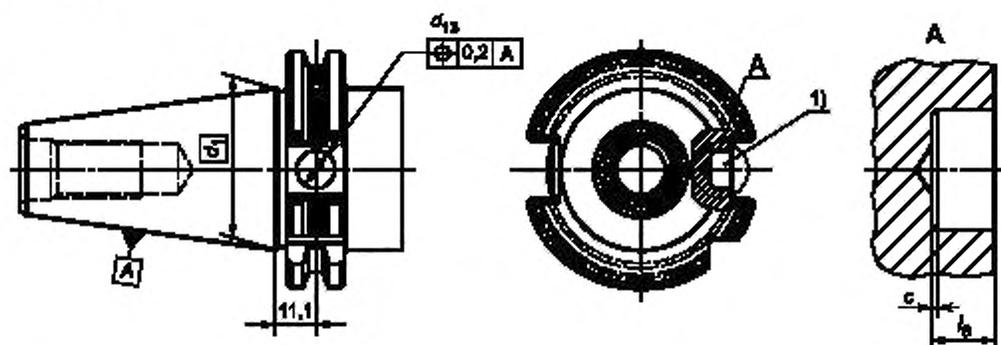
1) Гнездо для носителя информации расположено на оси расположения режущей кромки инструмента.
