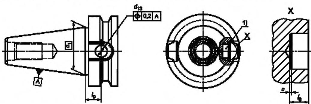
1) Гнездо для носителя информации расположено на оси расположения режущей кромки инструмента.
