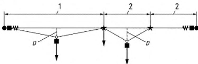
1 – наиболее длинный пролет; 2 – наиболее короткий пролет; *D* – динамическое отклонение; ■ – датчик нагрузки; ★ – промежуточный анкер; ○ – мобильная точка крепления; —→ – направление действия нагрузки; W – амортизатор энергии (при наличии); ● – крайний анкер
