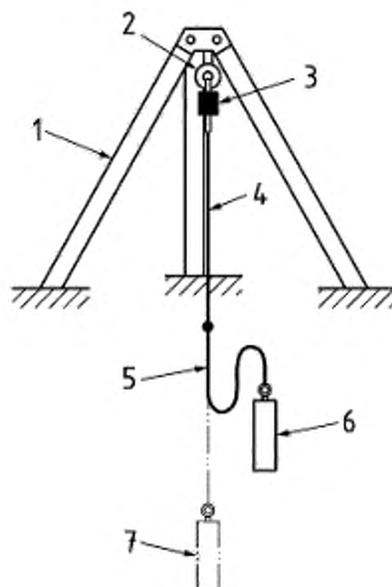
1 – тренога; 2 – точка(и) крепления не на ноге; 3 – датчик нагрузки; 4 – соединительная линия; 5 – строп для испытаний; 6 – положение испытательного груза перед отпусканьем; 7 – положение испытательного груза после отпусканья
