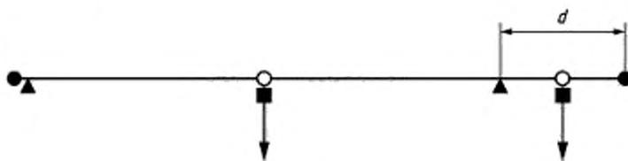
■ – датчик нагрузки; ▲ – фиксация жесткой анкерной линии; —> – направление действия нагрузки; ● – конечный упор; ○ – мобильная точка крепления;  $d$  – консольное расстояние
