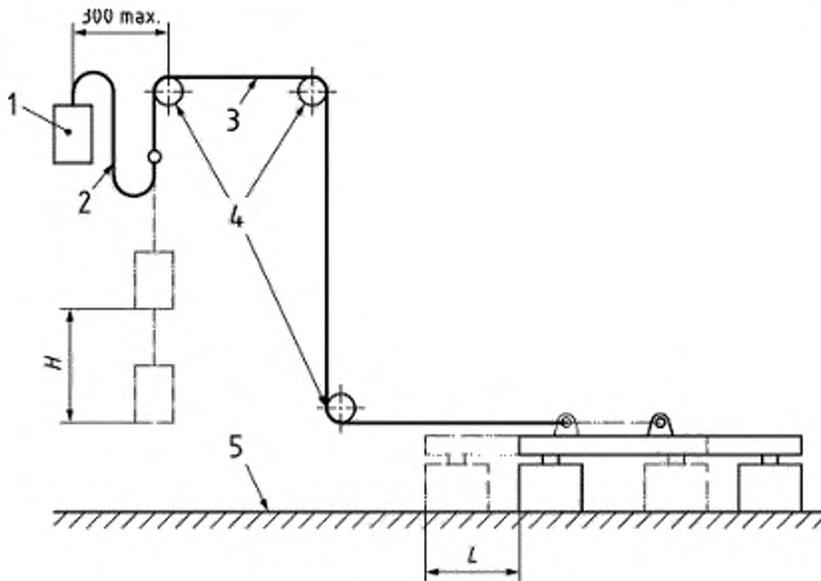
1 – жесткий испытательный груз; 2 – строп для испытаний; 3 – линия соединения;  $H$ ,  $L$  – перемещение жесткого испытательного груза; 4 – ролики; 5 – поверхность для испытаний
