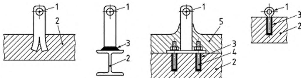
1 – точка крепления; 2 – структура; 3 – стационарная фиксация (например, штифтовое соединение, винты, заклепки, сварки или полимерная связка); 4 – структурный анкер; 5 – бетонное, изоляционное или иное покрытие
