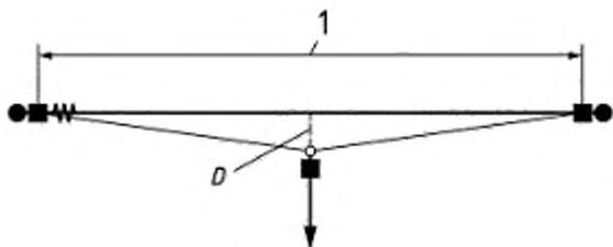
1 – наибольшая/наименьшая длина пролета;  $D$  – динамическое отклонение;  $\longrightarrow$  – направление нагрузки;  $\blacksquare$  – датчик нагрузки;  $W$  – амортизатор энергии (при наличии);  $\bullet$  – крайний анкер
