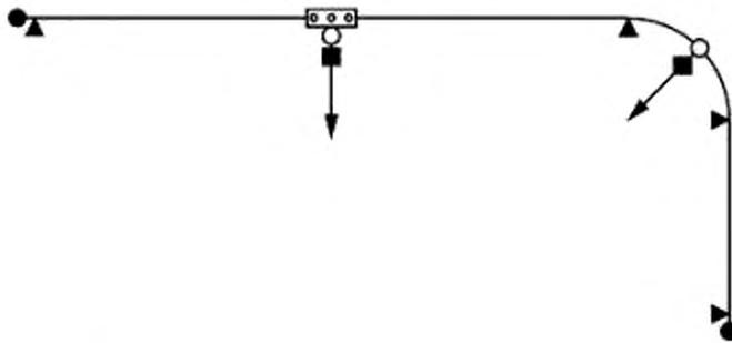
■ – датчик нагрузки; ▲ – фиксация жесткой анкерной линии; → – направление действия нагрузки; ● – конечный упор; ○ – мобильная точка крепления; ▭○○○ – соединение или разветвление жесткой анкерной линии
