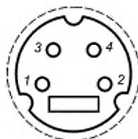
Рисунок 1 — Обозначение контактов
