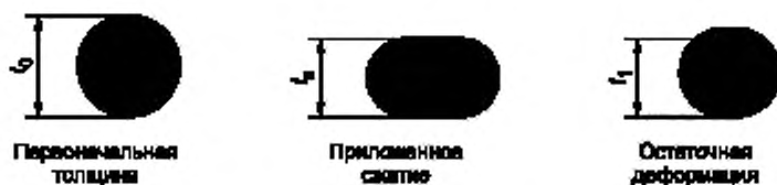
Рисунок 6 — Остаточная деформация при сжатии уплотнительного кольца
