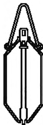
Рисунок 7 — Донный или зонный пробоотборник (вид в разрезе)
