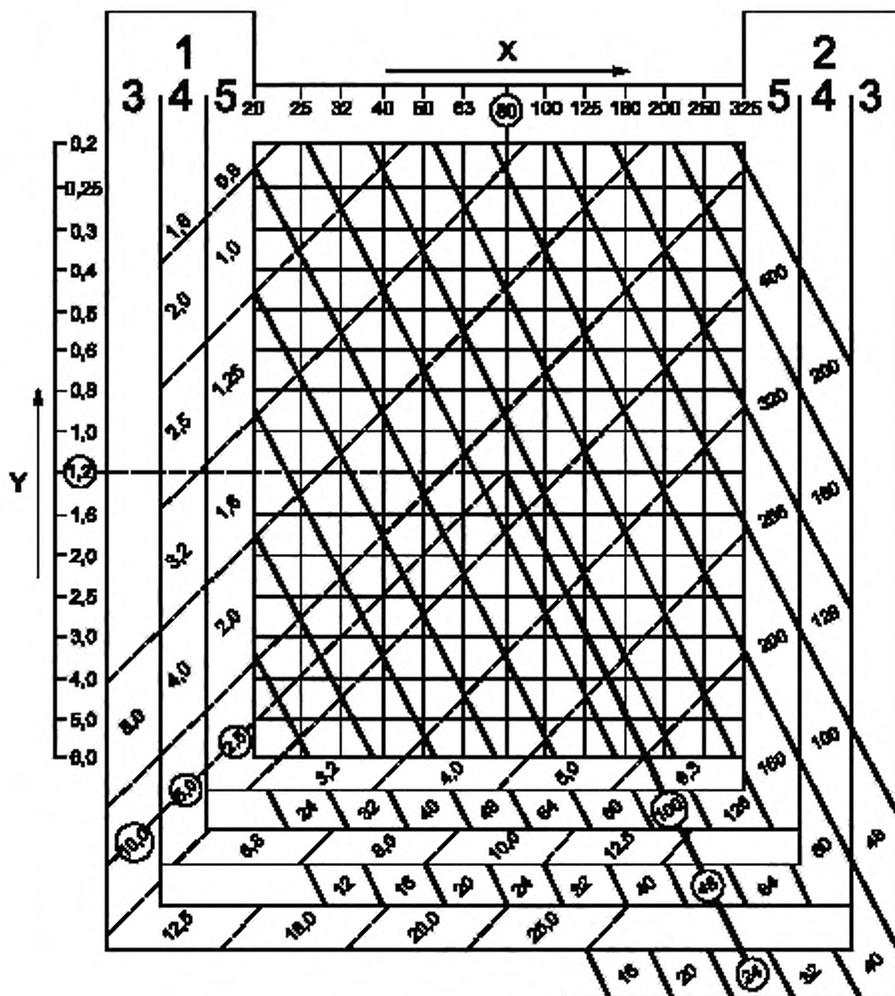
X — наружный диаметр фрезы; Y — ширина фрезы;
