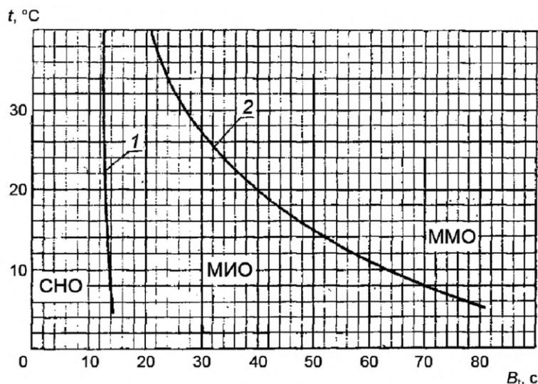
1 — для масла с вязкостью 5 мм<sup>2</sup>/с (сСт) при температуре 50 °С;
