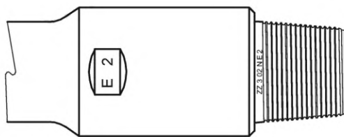
а) стандартное расположение желобка и заводская маркировка на трубе стандартной массы класса E;
