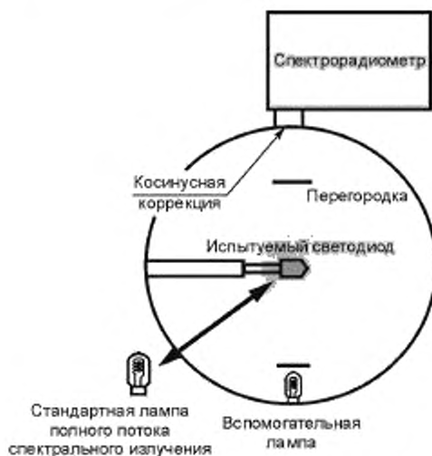
Рисунок 4 — Оптическая схема измерений в режиме полного потока
