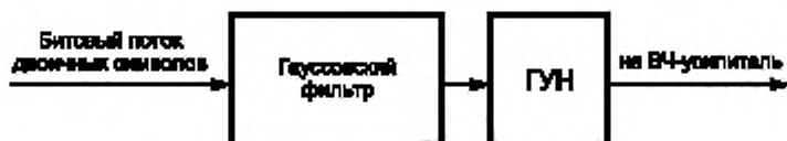
Рисунок 3 — Схема модулятора GMSK с ГУН
