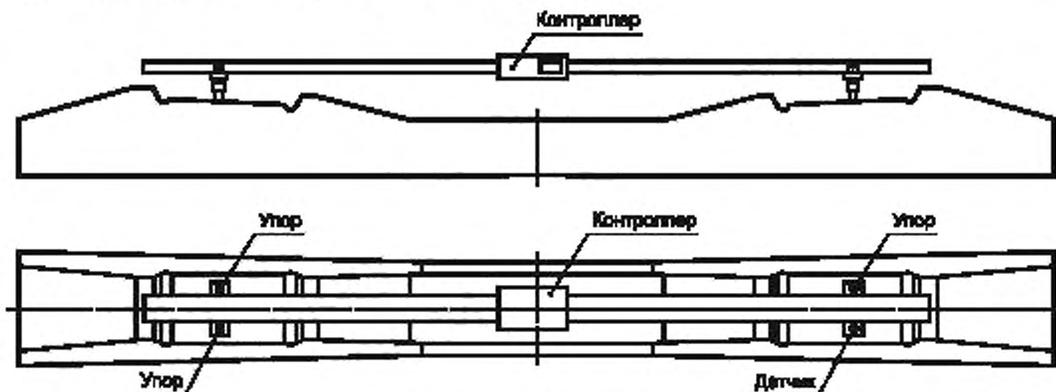
Рисунок 19 — Схема контроля пропеллерности подрельсовых площадок прибором ПКП-01Ш
