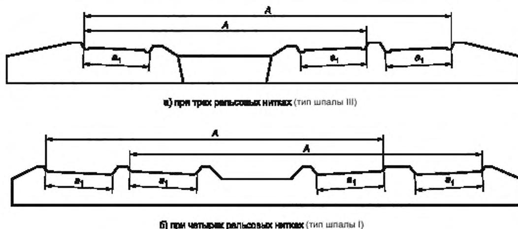
Рисунок 4 — Связки шпал с совмещенной колеёй разной ширины
