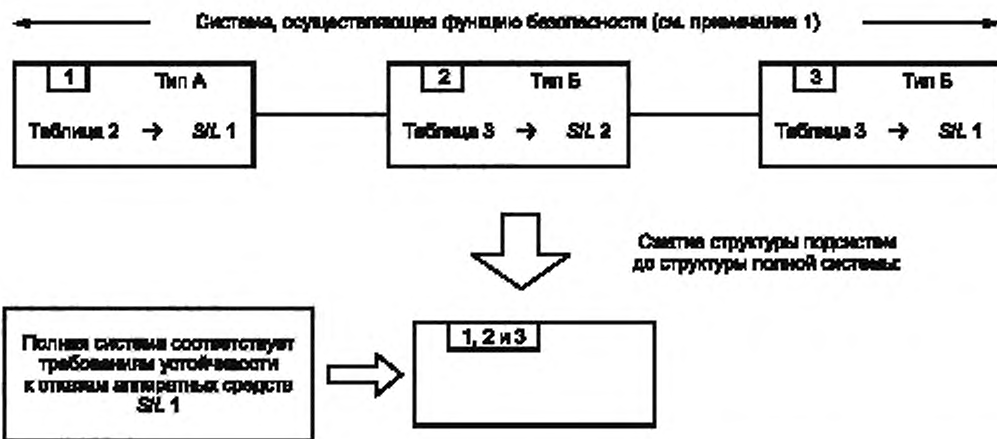
Рисунок 4 — Пример ограничения полноты безопасности АС для одноканальной структуры E/E/PE-системы, реализующей функцию безопасности
