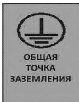
Рисунок 4 — Пример этикетки общей точки заземления для МКСМ типа С
