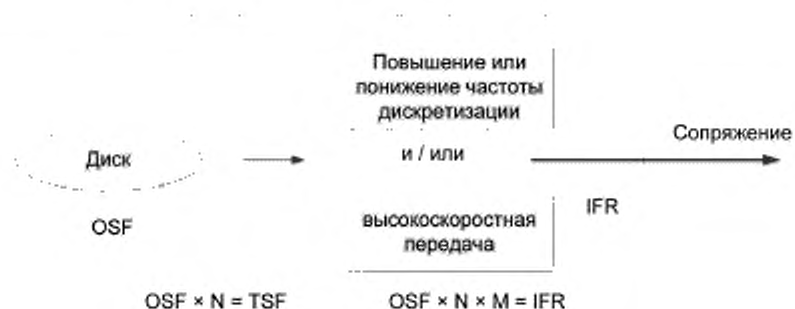
Рисунок Q.1 — Модель проигрывателя и сопряжения
