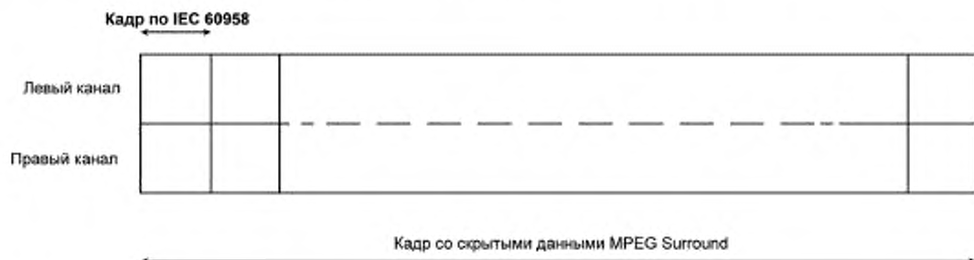
Рисунок U.1 — Соотнесение кадра со скрытыми данными MPEG Surround и кадра по настоящему стандарту
