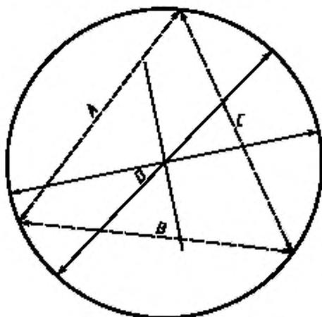
Рисунок 3 — Схема расчета наименьшего диаметра окружности поворота
