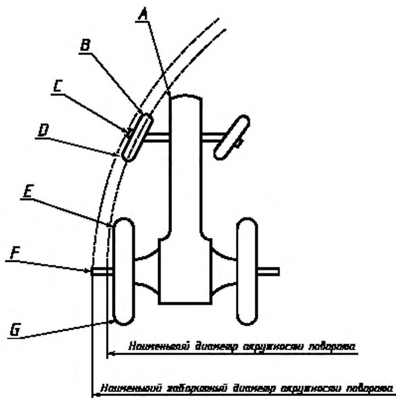
Рисунок 1 — Схема определения диаметров окружности поворота
