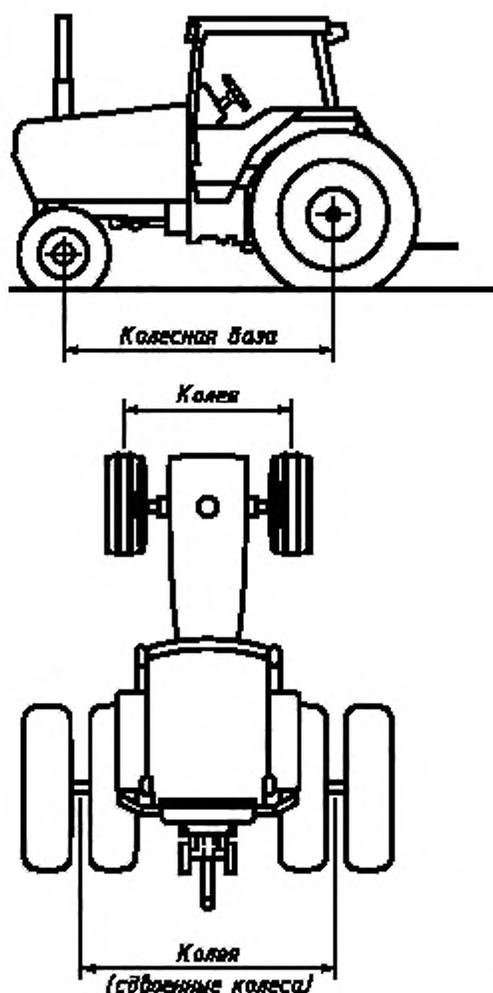
Рисунок 2 — Колесная база и ширина колеи трактора
