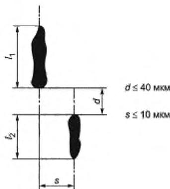
Рисунок 8 — Включения типов А и С
