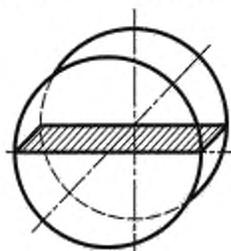
Рисунок 3 — Образец от прутка диаметром не более 25 мм
