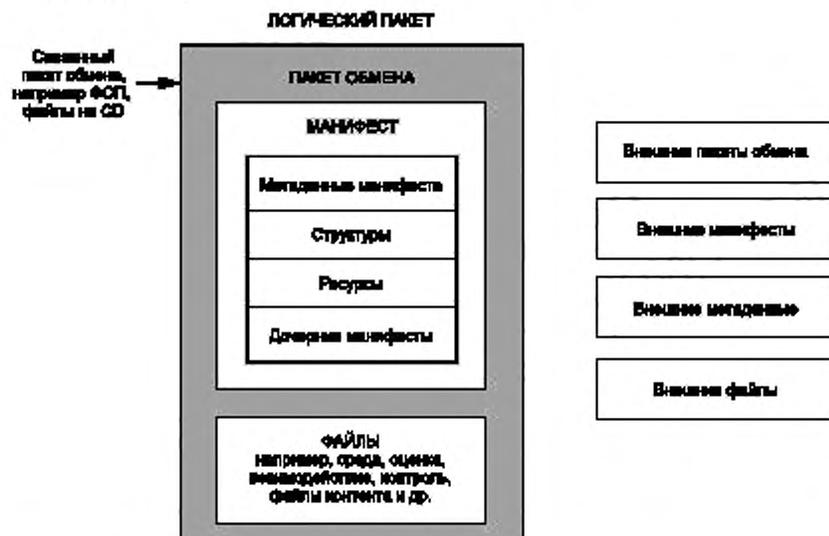
Рисунок 1 — Схематическое представление концептуальной модели упаковки контента (CPCM)
