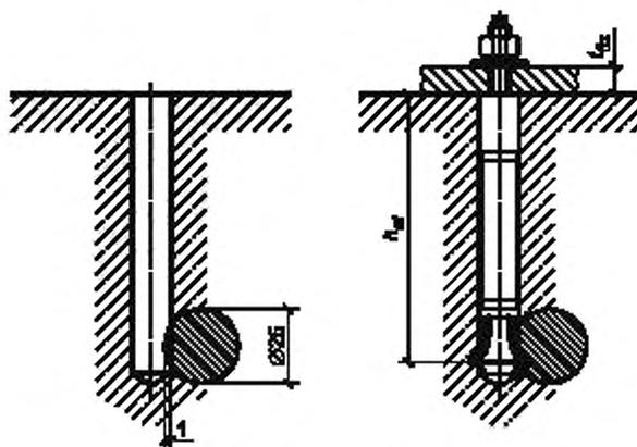
Рисунок 2 — Схема испытания анкера при влиянии армирования основания
