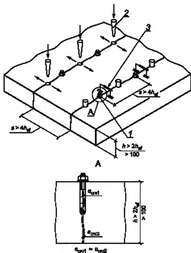
1 — анкер; 2 — клин; 3 — индикатор измерения ширины раскрытия трещины
