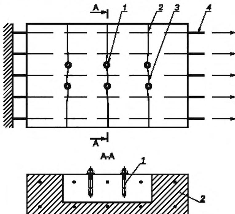
1 — анкер; 2 — инициатор трещины; 3 — трещина; 4 — арматура
