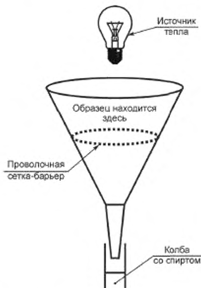
Рисунок D.1 — Устройство для выделения типа Туллгрена
