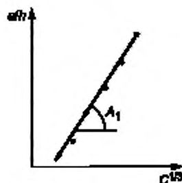
Рисунок 8 — Схема определения коэффициента A_1
