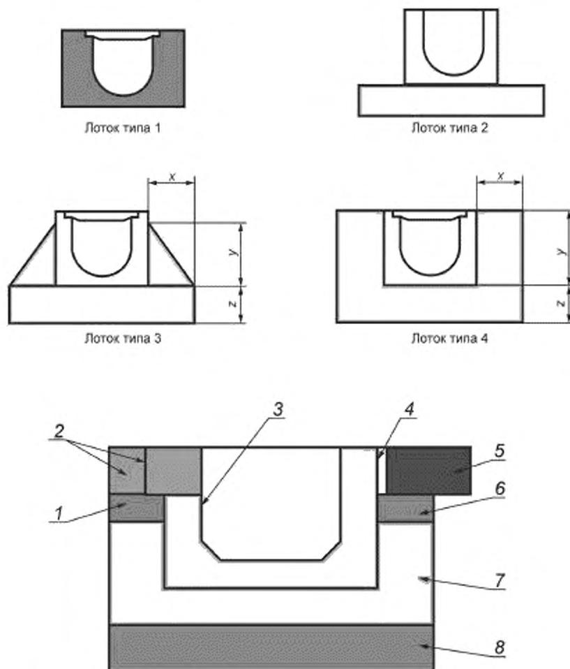
$x$ ,  $y$  и  $z$  — геометрические размеры несущего фундамента и обмуровки
