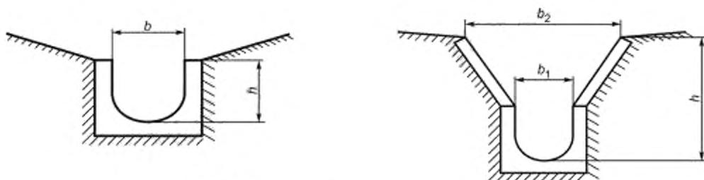
$h, b (b_1, b_2)$  — внутренние размеры (смачиваемый периметр)
