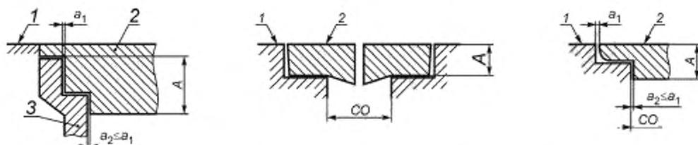
1 — поверхность прилегающего покрытия автомобильной дороги или пешеходной зоны; 2 — водоприемная решетка; 3 — стенка лотка;  $a_1, a_2$  — ширина щелей между корпусом лотка и решеткой;  $CO$  — ширина просвета лотка;  $A$  — глубина посадки решетки
