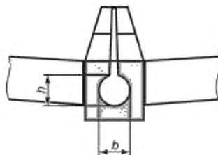
$h$ ,  $b$  — внутренние размеры (смачиваемый периметр)
