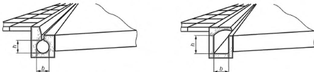
$h$ ,  $b$  — внутренние размеры (смачиваемый периметр)
