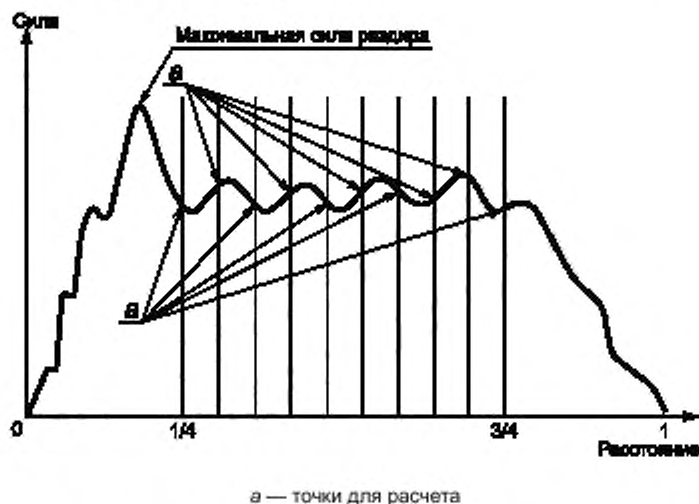
Рисунок 4 — Пример графического расчета сопротивления раздиру сварного (клеевого) соединения
