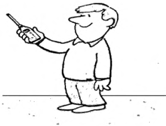
Рисунок 2 — Пример перемещения шумомера во время измерений
