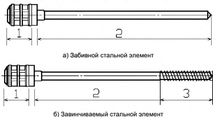
1 — теплоизоляционная головка; 2 — рядовая зона; 3 — резьбовая зона
