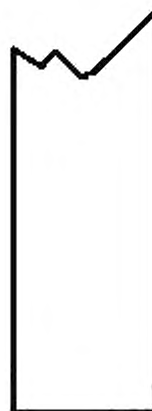
Рисунок Г.10 — Разрушение при сжатии типа AGM: разрушение через центр отверстия вдоль осей армирования слоев ламината, в основном расположенных под углом \pm 45^\circ
