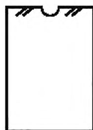
Рисунок Г.6 — Разрушение при растяжении типа LGM: поперечный отрыв через центр отверстия (может сопровождаться расслаиванием и разделением на части)
