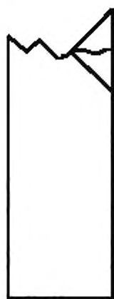
Рисунок Г.11 — Разрушение при сжатии типа MGM: многотиповое разрушение через центр отверстия
