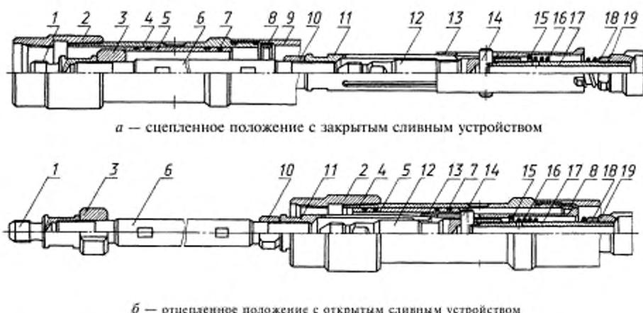
1 — переводник штока; 2 — муфта; 3 — центратор; 4, 17 — патрубki; 5 — золотник; 6 — шток; 7 — резиновое кольцо; 8 — упор; 9 — цилиндр; 10, 18 — контргайки; 11 — цапговый захват; 12 — сердечник; 13 — стакан захвата; 14 — вкладыш; 15 — кольцо; 16 — пружина; 19 — клетка плунжера
