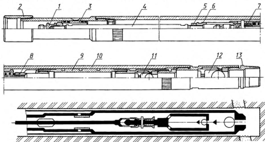
1 — переводник штока; 2 — верхний переводник; 3 — сливное устройство; 4 — шток; 5 — контргайка; 6 — цапговый захват; 7 — сцепляющее устройство; 8 — переводник плунжера; 9 — плунжер; 10 — цилиндр; 11 — нагнетательный клапан; 12 — всасывающий клапан; 13 — переводник насоса
