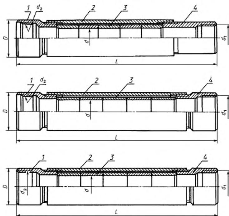
1 — переводник цилиндра; 2 — корпус; 3 — втулки; 4 — переводник удлинителя
