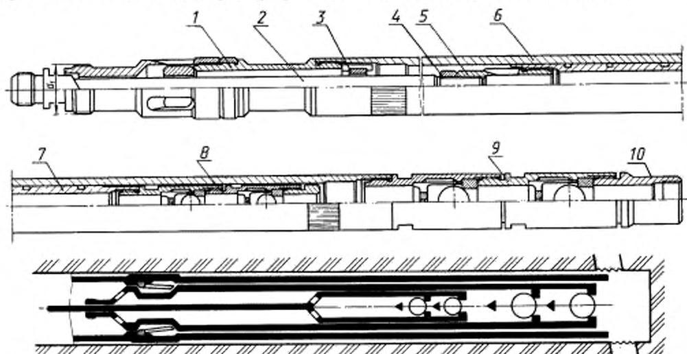
1 — замок и уплотнение насоса; 2 — шток; 3 — упор; 4 — контргайка; 5 — переводник плунжера; 6 — цилиндр; 7 — плунжер;
