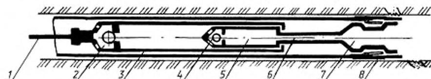
1 — шток; 2 — нагнетательный клапан; 3 — цилиндр; 4 — всасывающий клапан; 5 — плунжер; 6 — патрубок-удлинитель; 7 — упорный шпиль с конусом; 8 — насосно-компрессорная труба с замковой опорой
