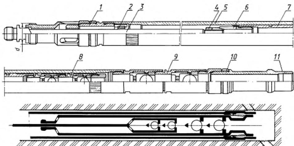
1 — защитный клапан; 2 — упор; 3 — шток; 4 — конграйка; 5 — цилиндр; 6 — переводник плунжера; 7 — плунжер; 8 — замковая опора; 9 — всасывающий клапан; 10 — упорный ниппель с конусом; 11 — переводник насоса
