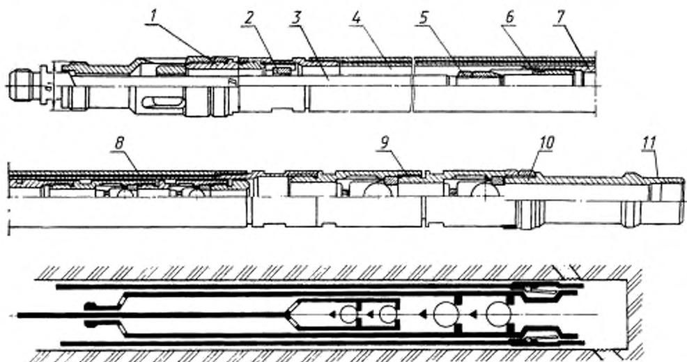
1 — защитный клапан; 2 — упор; 3 — шток; 4 — цилиндр; 5 — конграйка; 6 — переводник плунжера; 7 — плунжер; 8 — нагнетательный клапан; 9 — всасывающий клапан; 10 — замковая опора; 11 — переводник насоса
