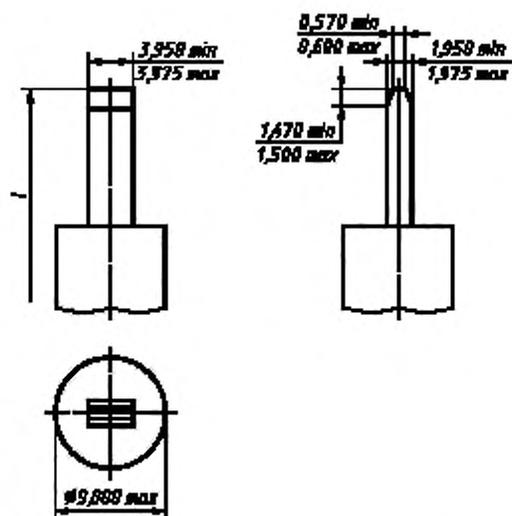
$l$  — длина калибра, обеспечивает испытательное усилие  $142^{+1.5}$  г
