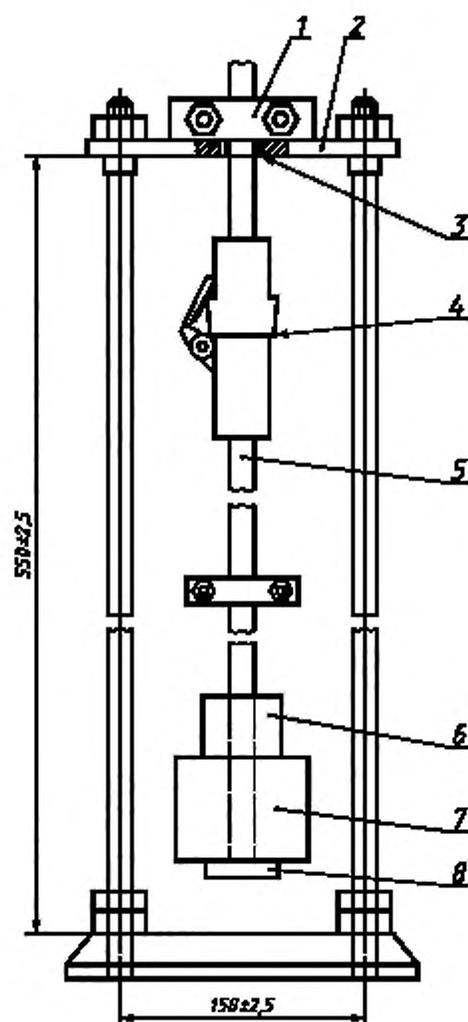
1 — анкерное крепление гибкого кабеля, 2 — монтажная плита, 3 — штулка; 4 — соединитель электроприбора; 5 — гибкий кабель; 6 — дополнительный груз; 7 — основной груз; 8 — фланец несущего устройства
