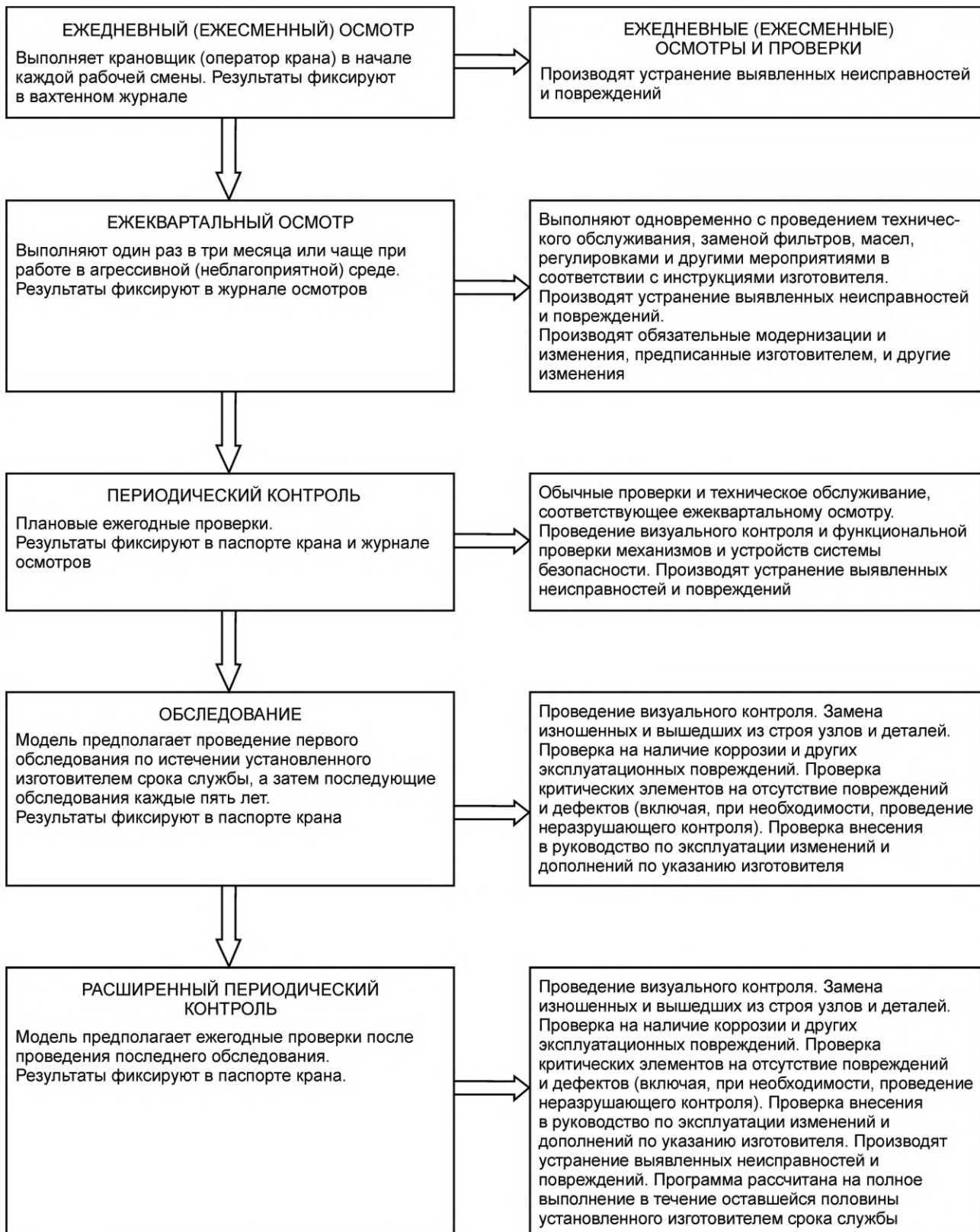
Рисунок Б.3 — Проведение технического контроля для кранов, отработавших более половины установленного изготовителем срока службы, в тех случаях, когда принята схема проведения технического контроля с применением обследования и, в дальнейшем, расширенного периодического контроля, а инструкции изготовителя отсутствуют или признаны некорректными
