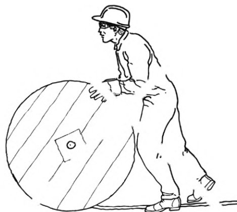
б) Разматывание каната с бобины
