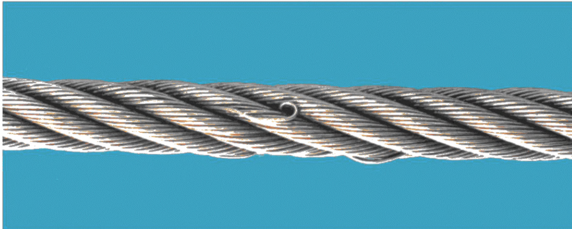
Рисунок А.1 — Выдавливание проволоочки из пряди
