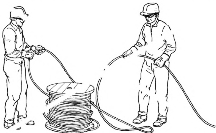
в) Разматывание каната с бобины
