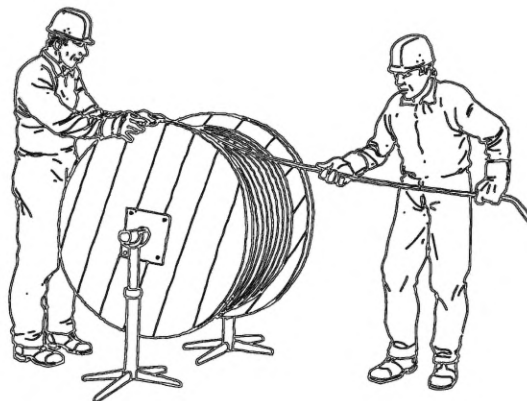
б) Разматывание каната с бобины
