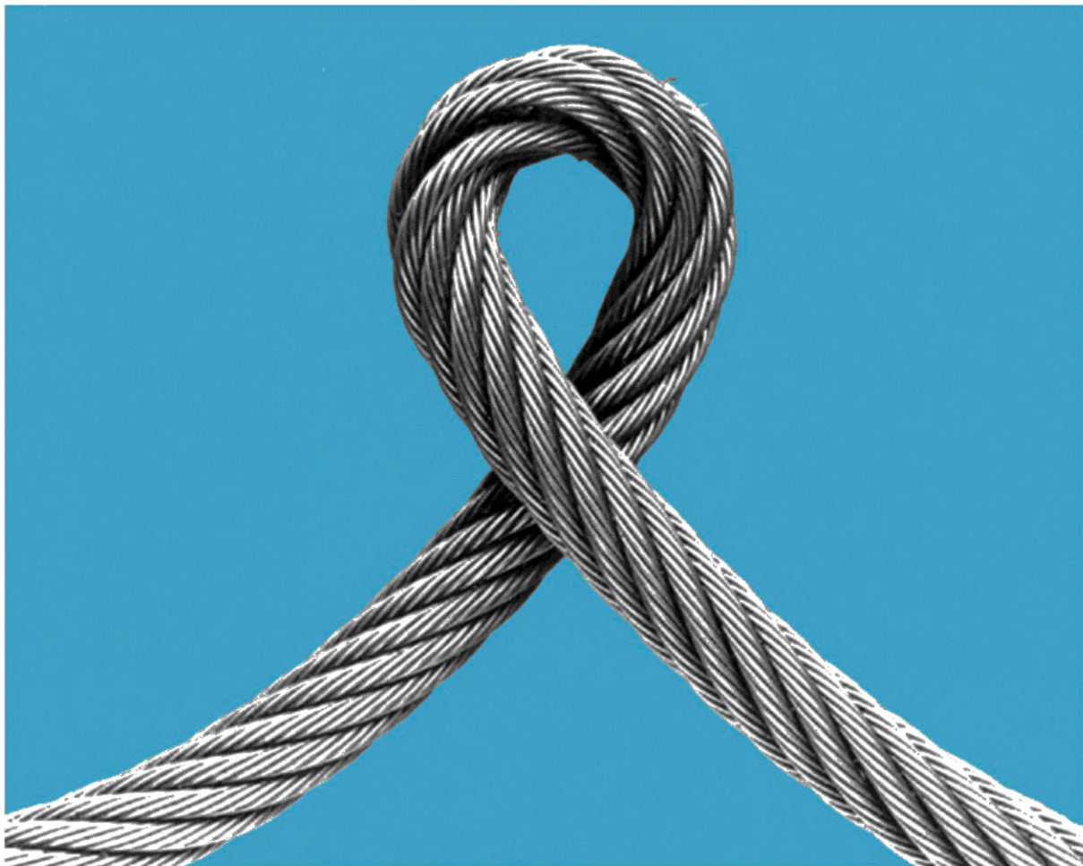
Рисунок А.17 — Перегиб каната
