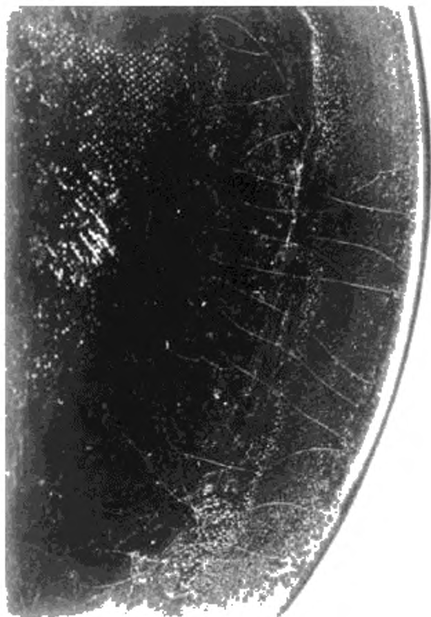
Рисунок А.2 — Волосяная трещина
