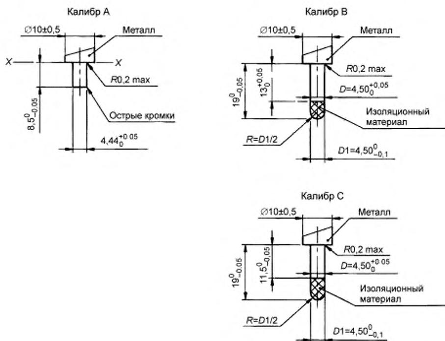
Рисунок 2 — Система вилок и штепсельных розеток на 16 А, 250 В переменного тока.
