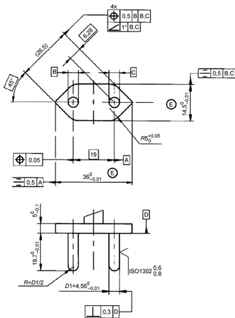
Рисунок 5В — Система вилок и штепсельных розеток на 16 А, 250 В переменного тока.
