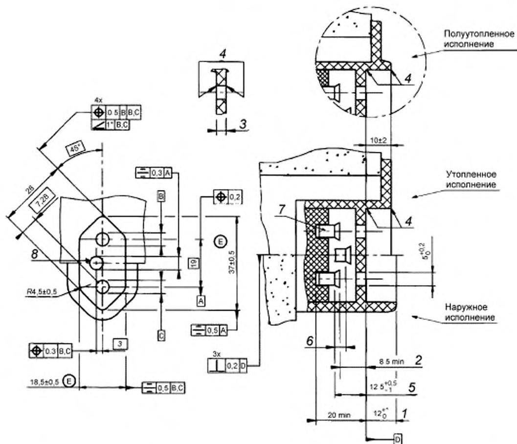
На рисунках приведены различные варианты установки штепсельных розеток: утолщенного, полу-утолщенного и наружного исполнения.
