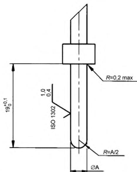
Рисунок 4 — Система вилок и штепсельных розеток на 16 А, 250 В переменного тока.
