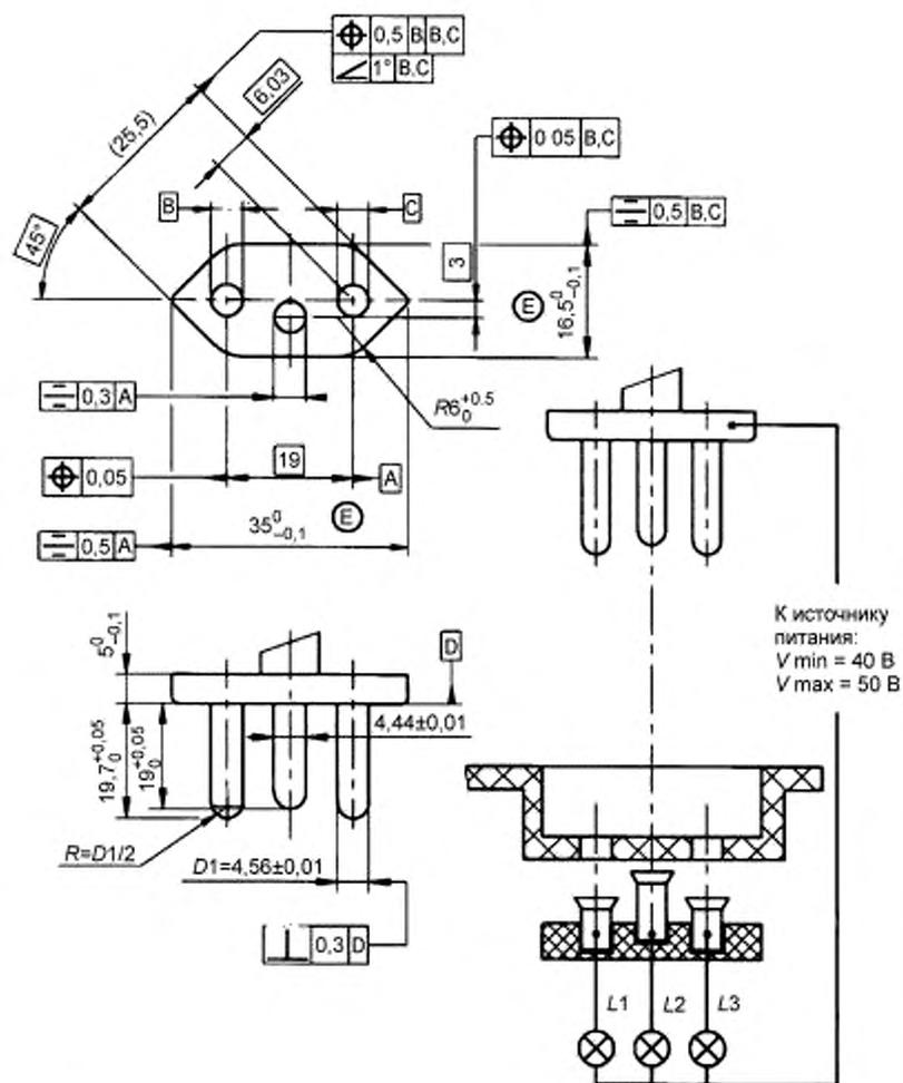
Рисунок 3 — Система вилок и штепсельных розеток на 16 А, 250 В переменного тока.
