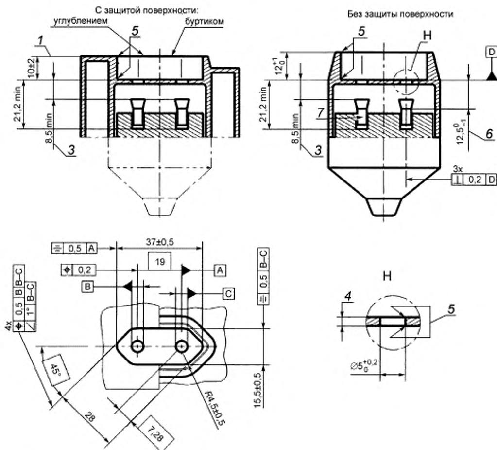
Приведенные рисунки не отражают конструкцию, за исключением размеров. Они могут быть использованы для различных исполнений, например для многоместных штепсельных розеток.
