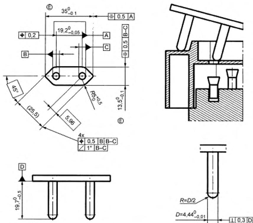
Рисунок 1 — Система вилок и штепсельных розеток на 16 А, 250 В переменного тока.
