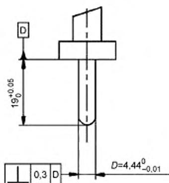
Рисунок 6 — Система вилок и штепсельных розеток на 16 А, 250 В переменного тока.
