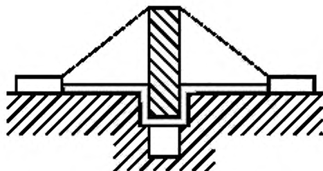
Рисунок E.8 — Расстояние утечки на примере 7
