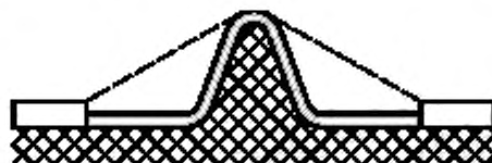
Рисунок E.4 — Расстояние утечки на примере 3
