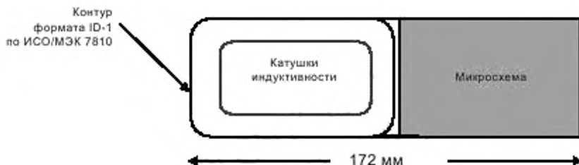
Рисунок 4 — Размеры эталонной PICC
