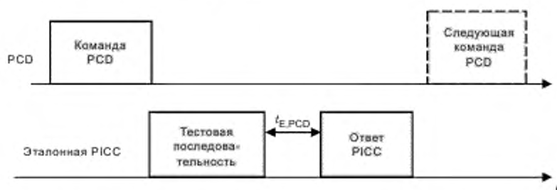
Рисунок Amd.2.2 — Последовательность испытания на восстановление после воздействия EMD (общая для типа А и типа В)
