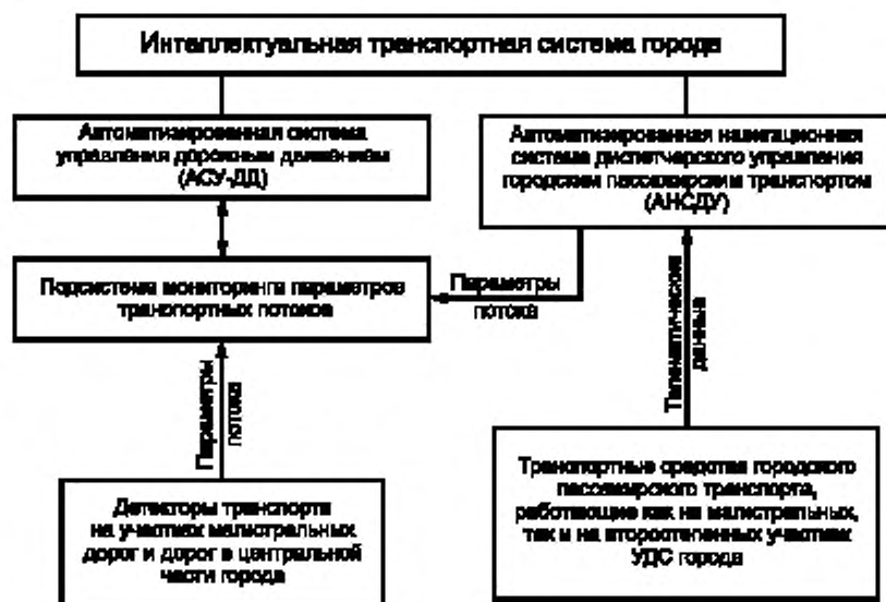
Рисунок 1 — Архитектура подсистемы мониторинга параметров транспортных потоков и ее взаимодействие с другими подсистемами ИТС города
